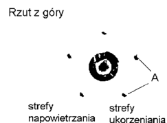
Rys. 6. Przykład ekologicznego zabezpieczenia drzewa z bryłą korzeniową na placu składowym (wg [10])
